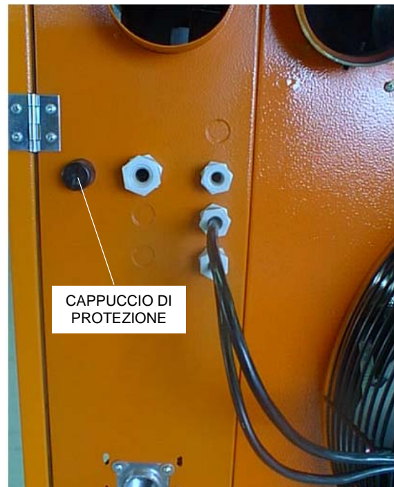
FIGURA 30 – QUADRO STRUMENTI (ALIMENTAZIONI)
